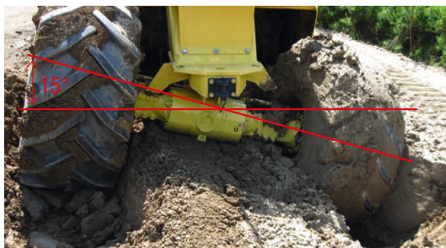
Ведущий мост с углом качания \pm 15^\circ .
