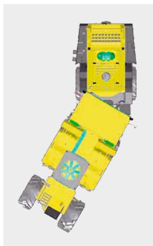
Управление путем излома шарнирно-сочлененной рамы.
