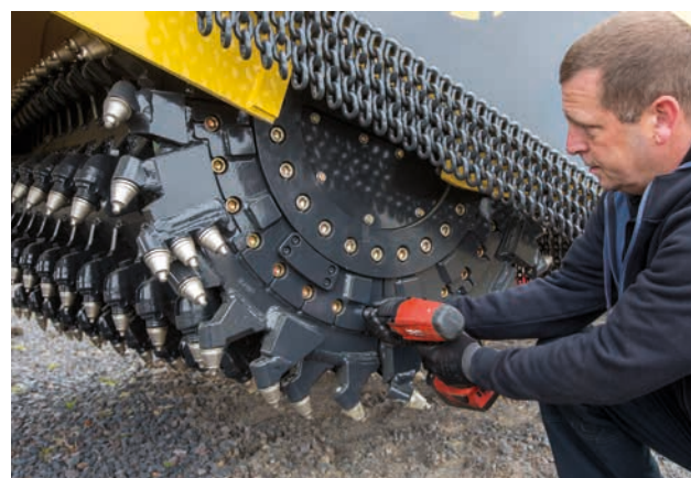
Смена краевых сегментов без необходимости демонтажа ротора.
